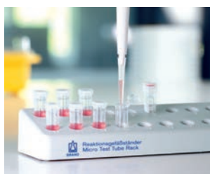
Punta de pipeta 2 – 200 µl en un recipiente de reacción
