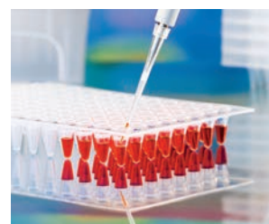
Punta con filtro 0,5 – 10 µl en placa para PCR
