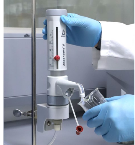
Dispensette® S über Rohrleitung mit einem Fass verbunden
