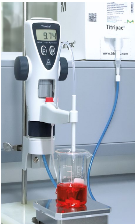
Entnahmesystem Titrette® für Bag-in-Box Verpackungssystem
