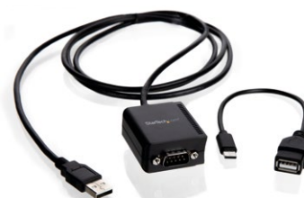
Kit adaptateur interface Interface RS232 vers USB pour Titrette®
