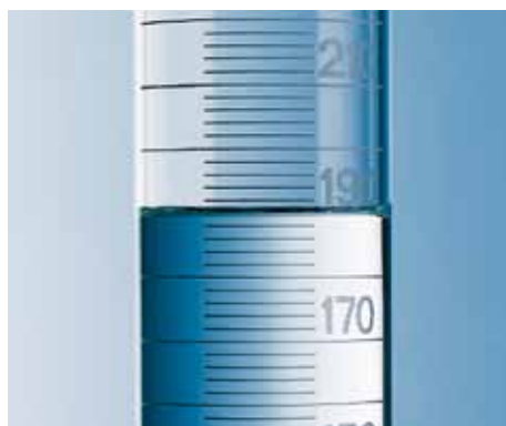
SILBERBRAND 。短刻度标记。读取凹液面最低点。
