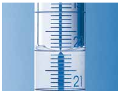
BLAUBRAND® Schellbach Stripe 标记 主刻度为环形。读取标记条的接触点。
