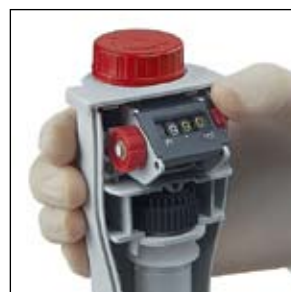
4. Roten Drehknopf und die Sicherungsscheibe wieder hineindrücken.
