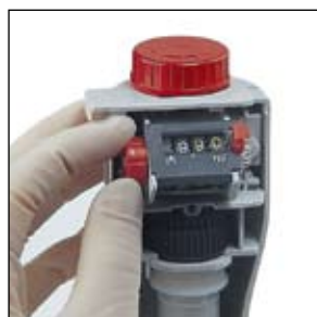
3. Roten Drehknopf herausziehen und den ermittelten Ist-Wert (hier 9,90 ml) einstellen.
