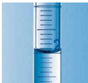
Graduation à marques circulaires aux points principaux
