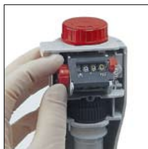
3. Retirer le bouton rotatif rouge et régler sur la valeur réelle obtenue (9,90 ml pour notre exemple).
