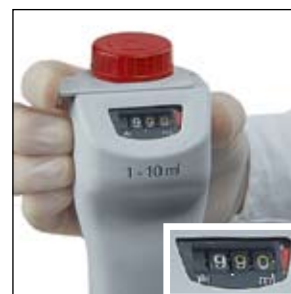
5. Zamknąć pokrywę – i gotowe! Zmiana ustawień fabrycznych sygnalizowana jest czerwonym znacznikiem.
