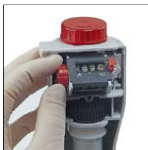
3. Wyciągnąć czerwone pokrętko i ustawić wartość uzyskaną podczas kontroli grawimetrycznej – wartość aktualną (w tym przypadku 9,90 ml).
