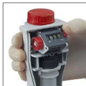
4. Wcisnąć na właściwe miejsce czerwone pokrętko oraz płytkę zabezpieczającą.
