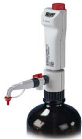
3. Wyciągnąć czerwone pokrętko i ustawić wartość uzyskaną podczas kontroli grawimetrycznej – wartość aktualną (w tym przypadku 9,90 ml).
