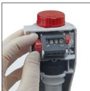
3. Retire o botão giratório vermelho e ajuste o valor real determinado (neste caso: 9,90 ml).
