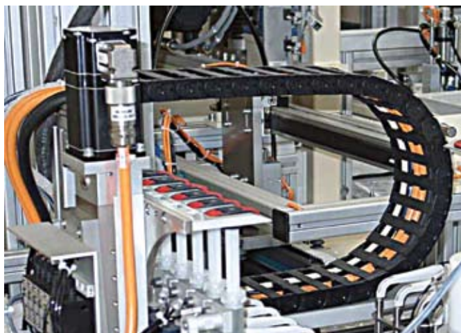
Equipo de dosificación de 12 canales (2 x 6 canales), sistema seripettor®:
