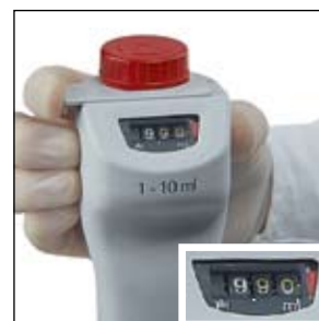
5. Cerrar la carcasa. ¡Listo! El cambio del ajuste de fábrica se indica por una señal roja.
