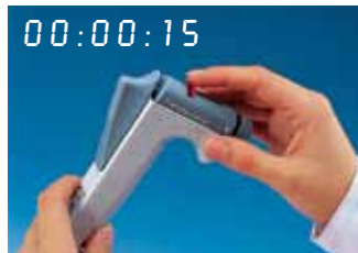
4. Sicherungsscheibe wieder hineindrücken.
