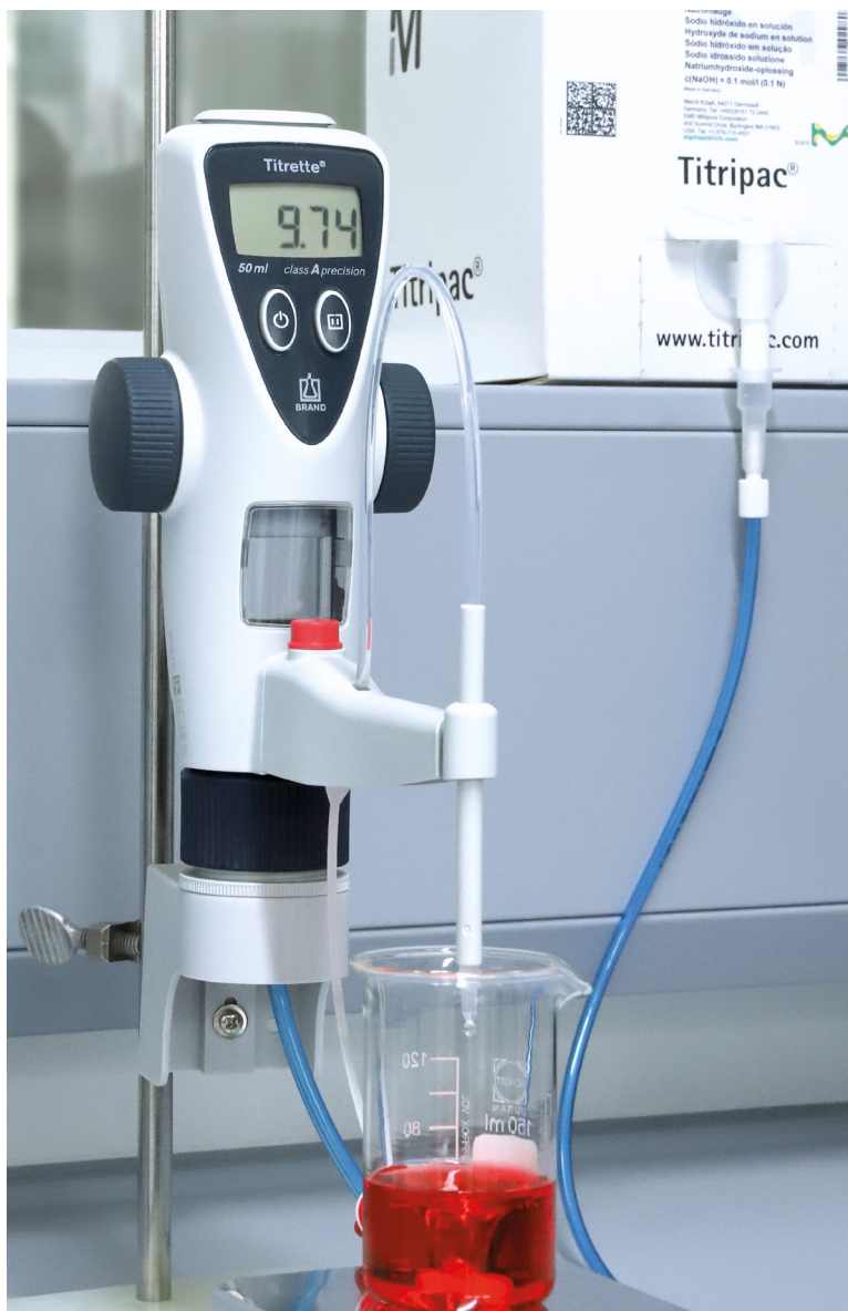
用于盒装储液袋的Titrette®取液滴定系统 (Titripac®是德国达姆施塔特 Merck KGaA 的注册商标)
