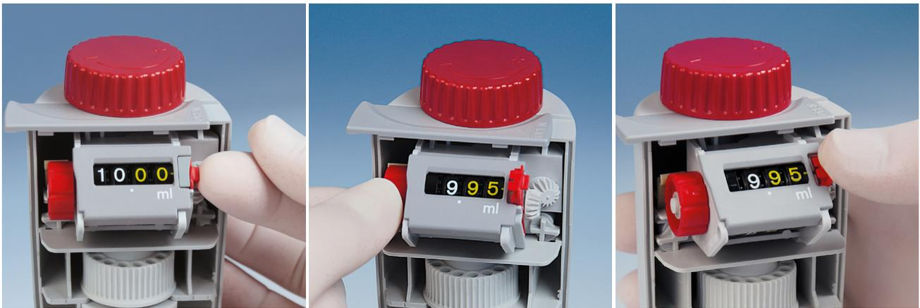
Justieren eines Flaschenaufsatz-Dispensers Dispensette® S Digital mit der Easy Calibration-Technik: das angezeigte Volumen wird dem tatsächlich gemessenen Volumen angepasst
