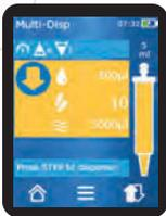
Die Dispenser Tips von BRAND ermöglichen durch die patentierte Codierung am Kolbenkopf eine automatische Größen-Erkennung. Nach dem Einsetzen wird die erkannte Tip-Größe im Display angezeigt. Das vermeidet Fehler und das zu dosierende Volumen und gewünschte Arbeitsprogramm kann nun einfach über das Touch-Display eingestellt werden. Alle we-
