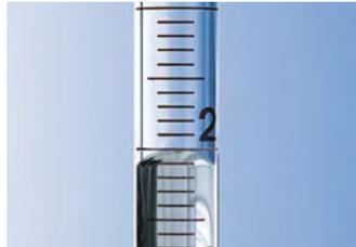
*Nach oben gekrümmter Meniskus in einer Messpipette.*
