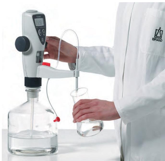
Durch Drehen der Handräder wird der Kolben bewegt und dadurch Flüssigkeit aufgesaugt bzw. abgegeben. Die Elektronik des Geräts erkennt durch die Drehrichtung automatisch, ob gefüllt oder titriert wird.
