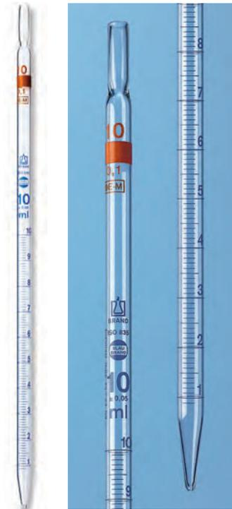
Messpipette Typ 2, Nennvolumen oben
