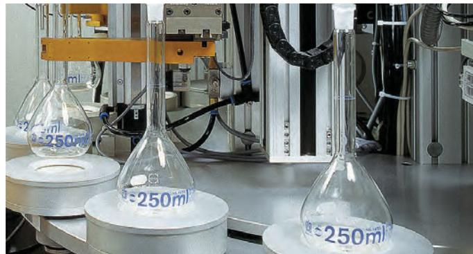
Maschinelle Bedruckung von Messkolben
