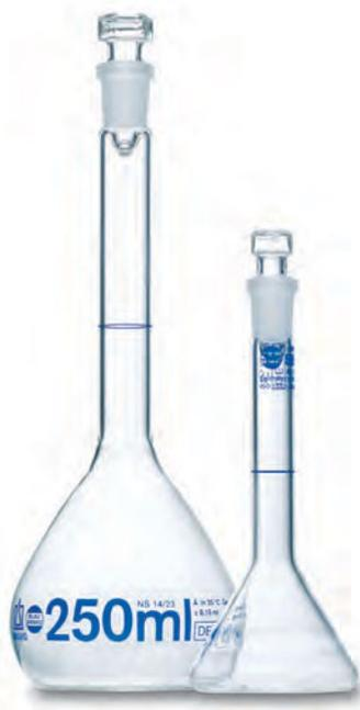
Messkolben sind auf 'In' justierte Messgeräte, Klasse A und B, die vorwiegend zum Herstellen von genauen Lösungen, z. B. Maß- und Standardlösungen, sowie zum Ansetzen von Verdünnungen verwendet werden.
