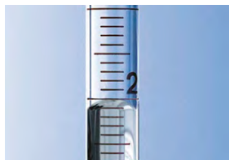
Ménisque convexe dans une pipette graduée.
