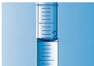
Ménisque concave dans une pipette graduée.
