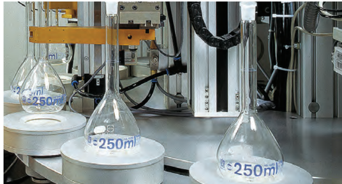
Réalisation automatisée des impressions sur les fioles jaugées
