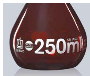
Protection UV en laboratoire avec la fiole jaugée en verre ambré
