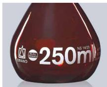
Protección UV en el laboratorio con el matraz aforado de vidrio topacio
