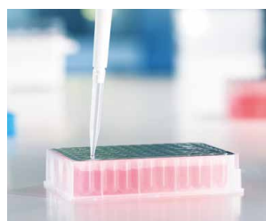
50 – 1000 µl Pipettenspitze in eine Deep-well Platte
