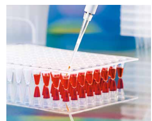
0,5 – 10 µl Filterspitze in PCR-Platte
