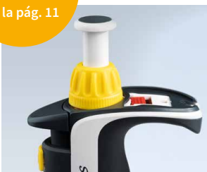
Técnica Easy Calibration: Ajuste sin herramientas
