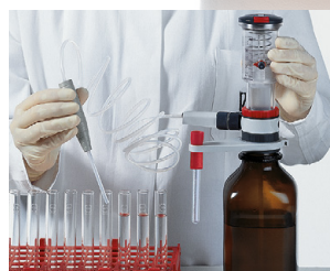
Seriendosierung mit flexiblem Dosierschlauch
