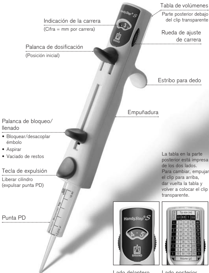
Lado delantero del ajuste de carrera
