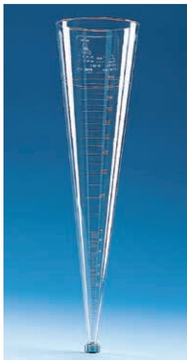
SAN材质，透明。 旋盖可供排水。 可承受温度最高可达85 °C。 1个/包。
