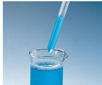
Zum Schäumen neigende Medien, wie Tensidlösungen, sind für den Transferpettor kein Problem.
