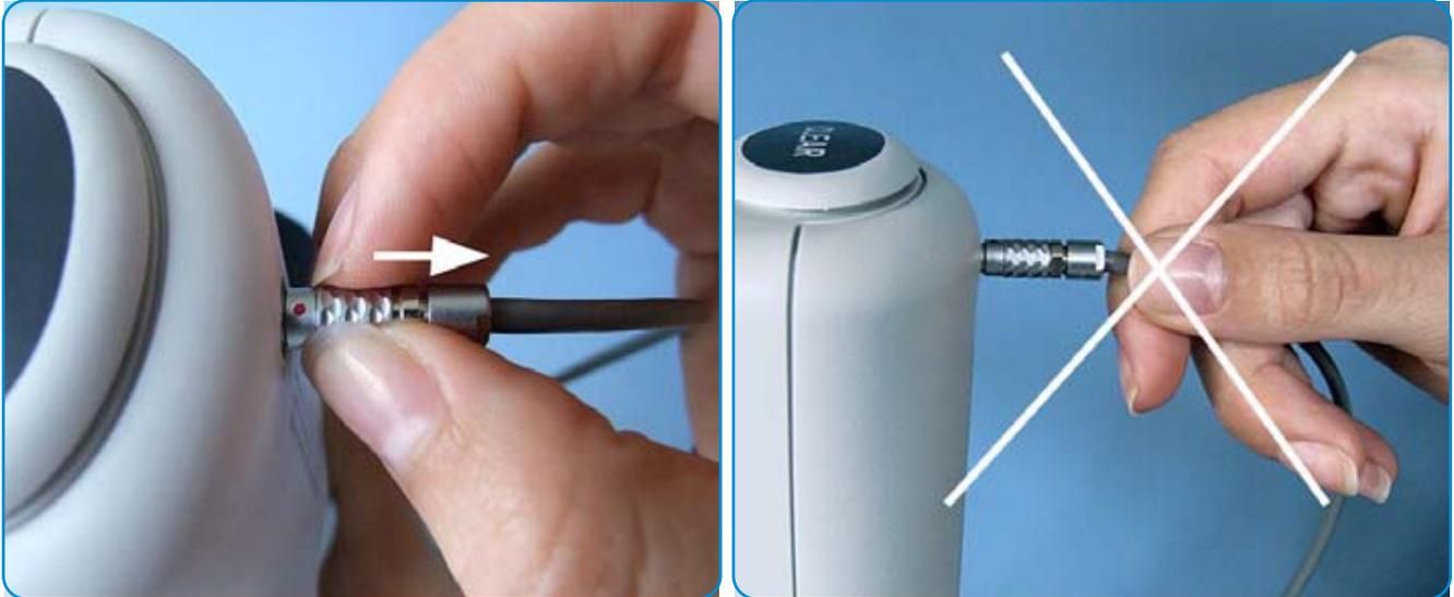
Den Stecker in die Gerätebuchse stecken, dabei zeigt der rote Punkt nach oben. Zum Entfernen des Steckers die Hülse nach hinten schieben. Niemals am Kabel ziehen!
